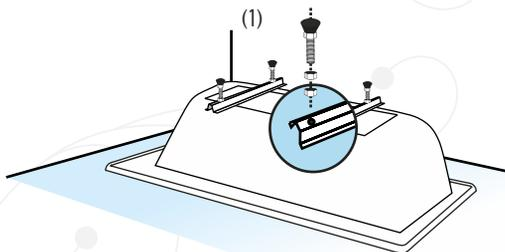
Βήμα α) Βιδώνουμε τις δύο ράβδους στήριξης στο κάτω μέρος της μπανιέρας και τοποθετούμε στα ανοίγματα τα πλαστικά πόδια αυξομειώσης ύψους. (Σχ. 1)
